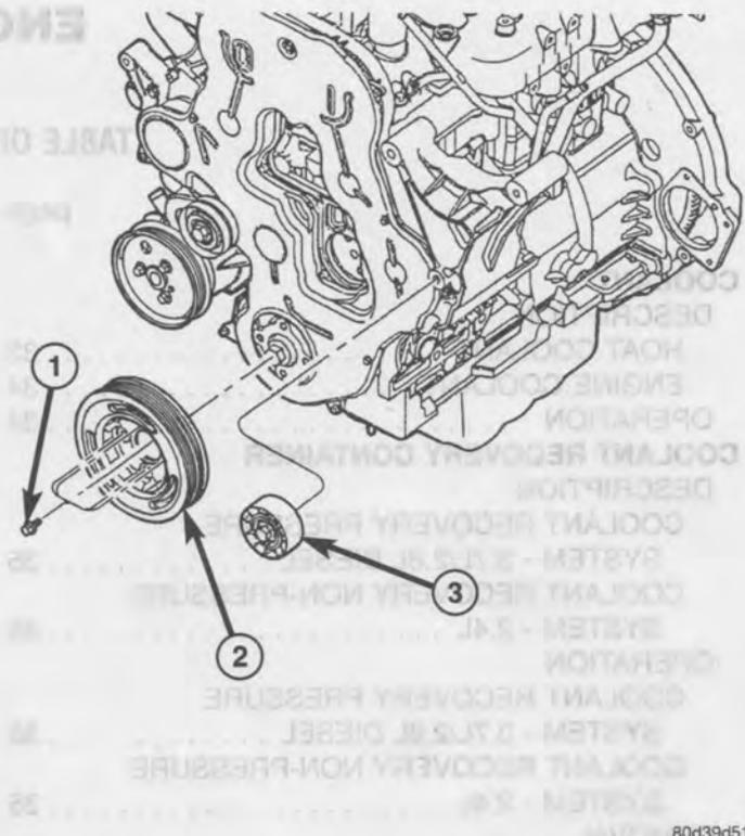
**Fig. 13 VIBRATION DAMPER AND IDLER PULLEY**
