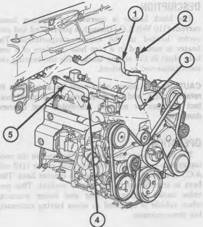
**Fig. 4 HEATER CORE COOLANT HOSES**
